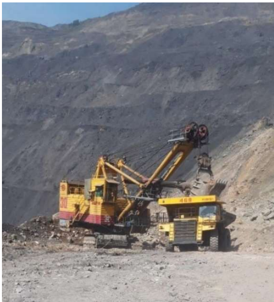
Hình 1. Vận hành máy xúc EKG-10 bốc xúc đất đá lên xe tải hạng nặng
