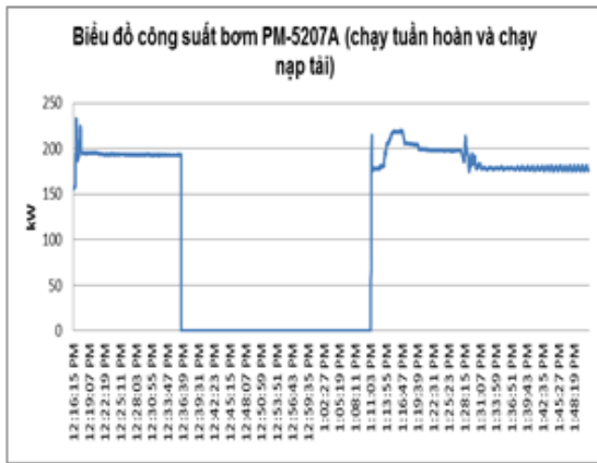
Hình 15. Biểu đồ công suất khi chạy tuần hoàn và cấp nạp tàu ( f=37,3 Hz), van bypass \sim 0\%
