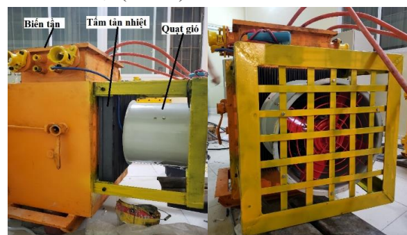
Hình 1: Biến tần làm mát bằng không khí do Viện Cơ khí Năng lượng và Mỏ - Vinacomin thiết kế và chế tạo
