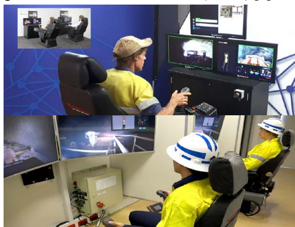
Hình 1: Các công nhân vận hành máy khai thác trong trung tâm điều khiển trên mặt đất
