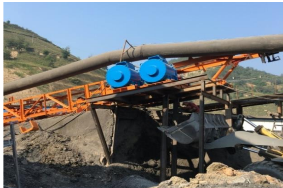
Hình 11. Động cơ LSPMSM của quạt tản nhiệt Nhà máy Xi măng Pingliang Qilianshan - Trung Quốc (2019)
