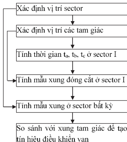
Hình 5. Lưu đồ thuật toán tính toán thời điểm phát xung điều khiển các van dẫn
