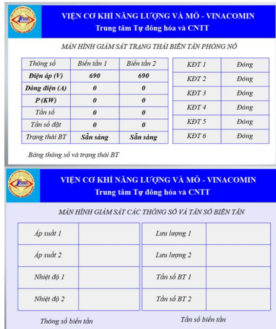
Hình 6: Giao diện quản lý, điều khiển và hiển thị thông số của biến tần
