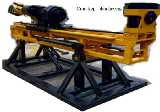
Hình 1: Cụm kẹp - dẫn hướng thủy lực lắp trên máy khoan VMG-700
