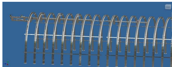
Hình 2: Mô phỏng áp dụng hệ thống hỗ trợ nâng hạ vì chống
