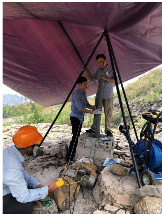
Hình 5: Quá trình thả và rút thanh slug khỏi lỗ khoan
