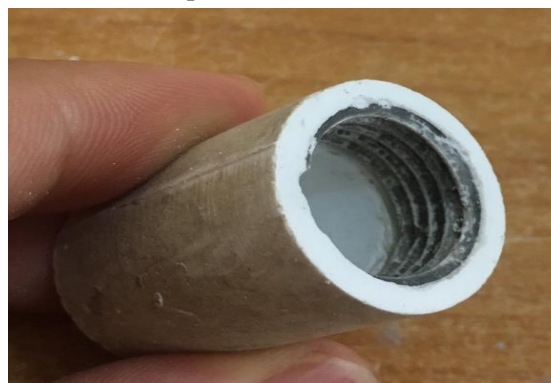
Hình 1: Mộc của mẫu ép ở áp lực 30 MPa cho chất lượng ren tốt
