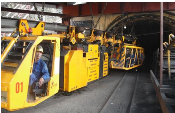
Hình 1: Hệ thống monorail vận chuyển người, thiết bị phụ trợ tại Công ty CP Than Hà Lâm
