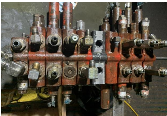
Hình 8: Hình ảnh sau khi lắp van phân phối thủy lực lên bộ van tổng thể của máy xúc DX55
