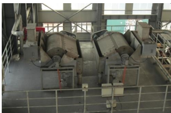
Hình 6. Máy tuyển từ MTT-80/170 tại Nhà máy sàng tuyển than Vàng Danh 2
