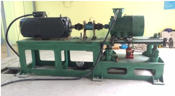
Hình 7. Dây chuyền thử nghiệm động cơ công suất 110 kW
