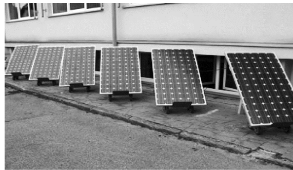
Hình 4. Bảng quang điện có thể điều chỉnh được
