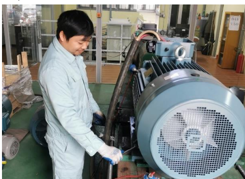
Hình 2. Dây chuyền thử nghiệm hiệu suất năng lượng động cơ điện
