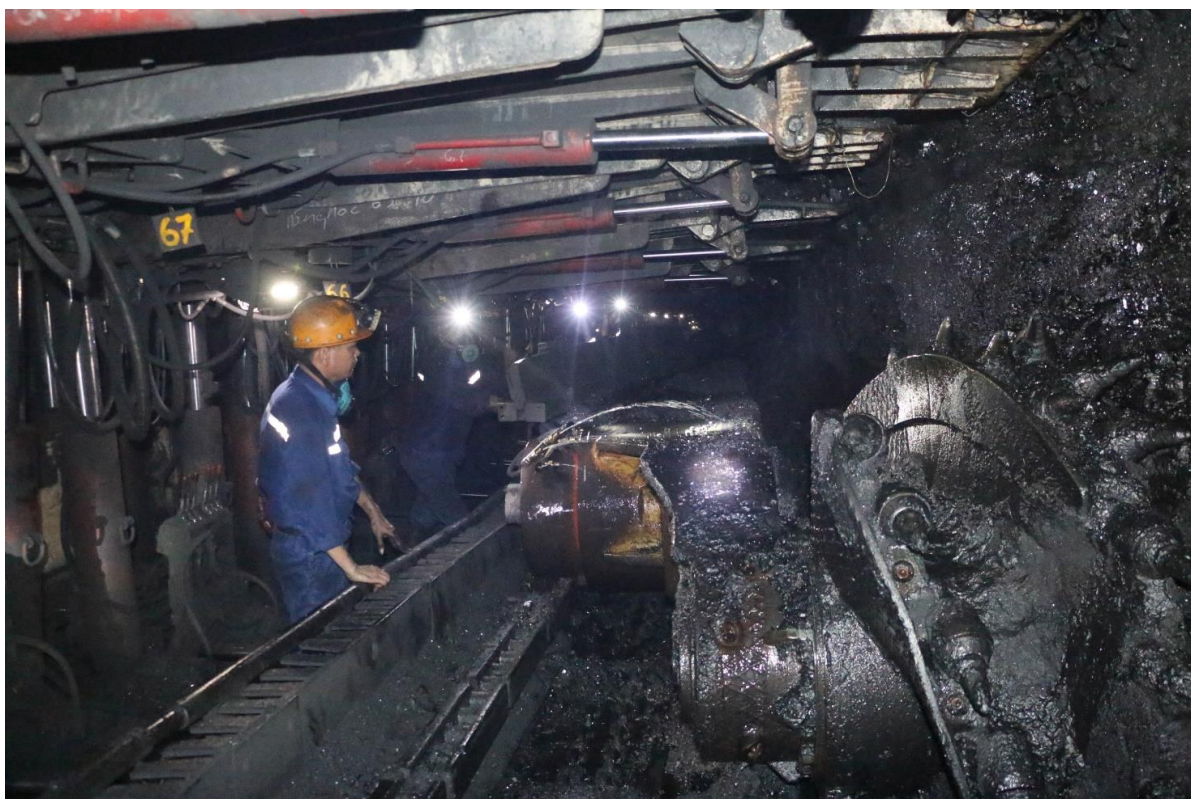
Công nhân Công ty CP Than Mông Dương điều khiển máy khâu than lò chợ CGH hạng nhẹ tại khu lò chợ VM-L(7)-1 mức -250/-100 vỉa 7
