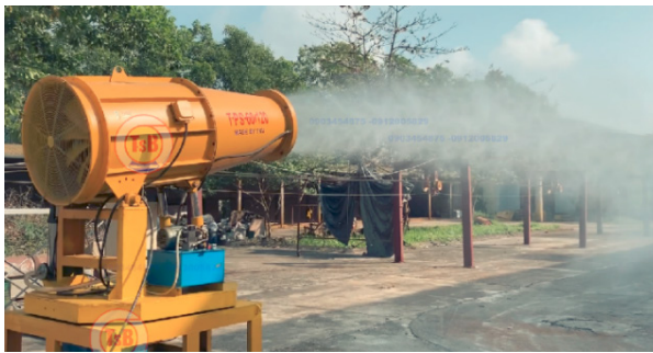
Hình 1 - Quạt máy phun sương dập bụi do Viện Cơ khí Năng lượng và Mỏ chế tạo
