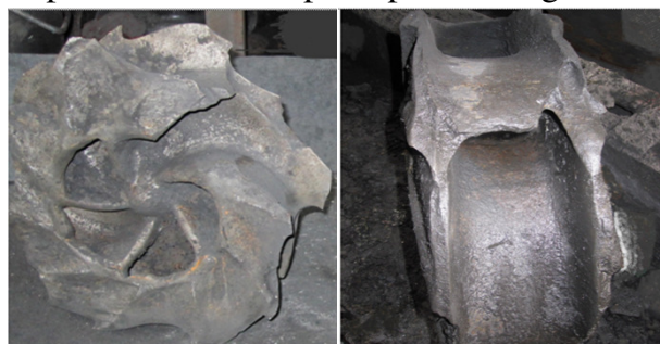
Hình 1. Bánh công tác máy bơm bùn bị mòn hỏng tại Nhà máy sàng tuyển than Vàng Danh
