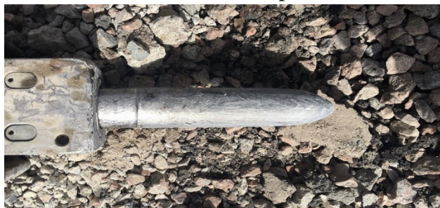
Hình 4. Hình dạng mũi búa thủy lực sau một thời gian làm việc
