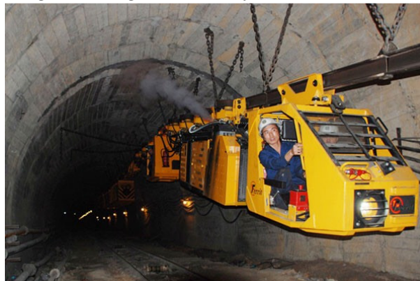
Hình 1. Đầu tàu mono ray phòng nổ
