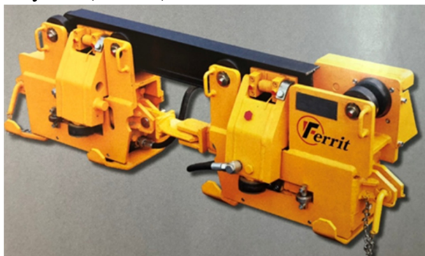
Hình 2. Bộ phanh hãm BTS của đầu tàu mono ray
