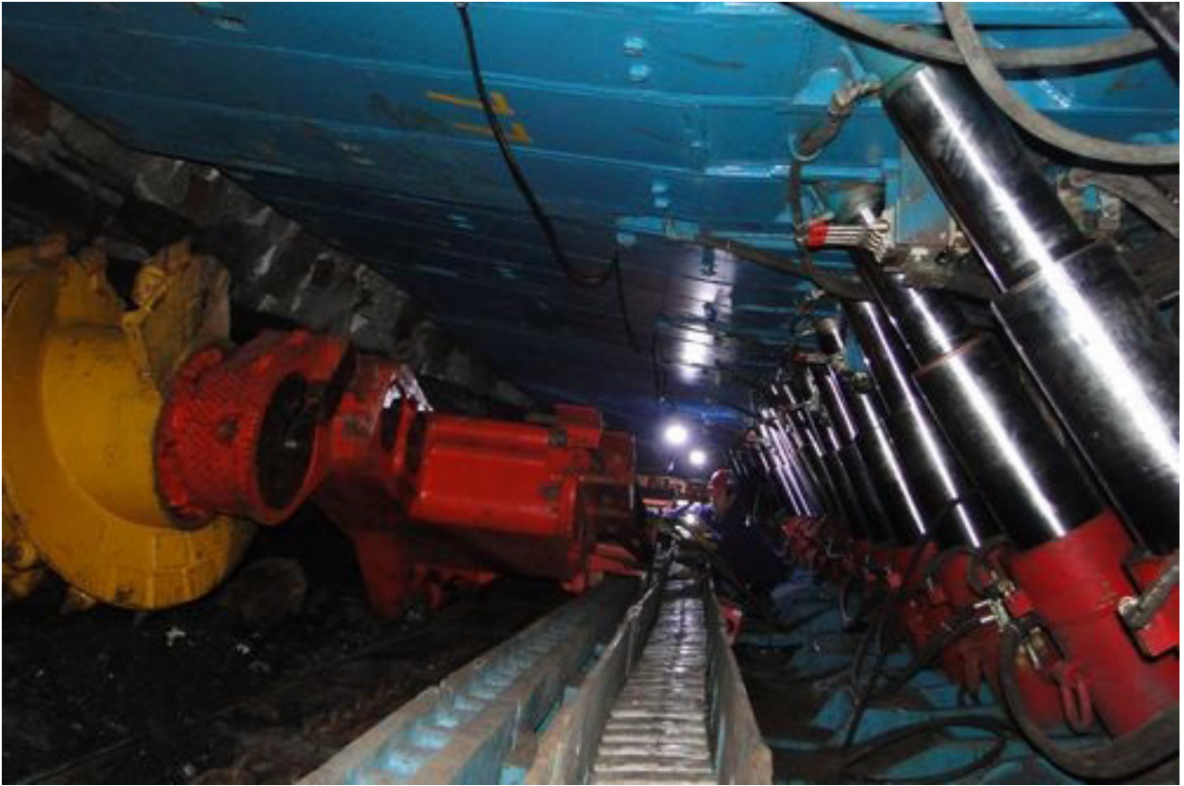
Hình 2: máy khẩu than trong lò chợ cơ giới hóa
