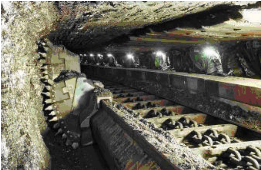
Hình 1: máy bào trong lò chợ cơ giới hóa
