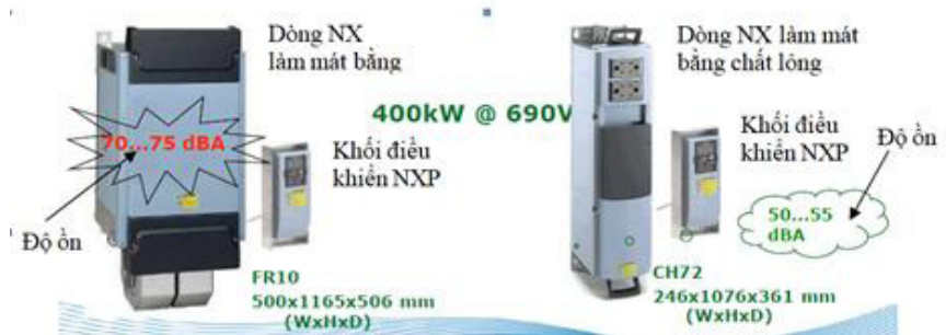
Hình 3. So sánh kích thước và độ ồn của hai biến tần làm mát bằng khí và bằng chất lỏng có công suất giống nhau 400kW của hãng Vacon.
