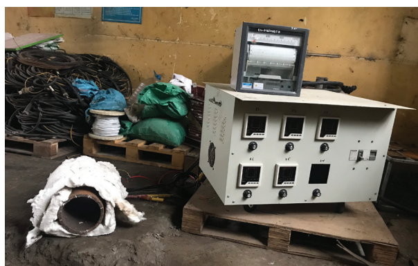
Hình 2. Thiết bị xử lý nhiệt mối hàn bằng điện trở sử dụng nguyên lý điều khiển dòng điện ra bằng Thyristor
