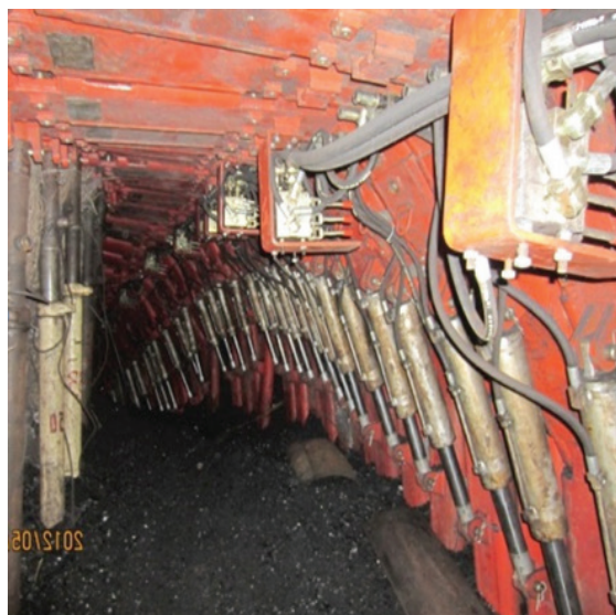
a) Lò chợ chống giữ bằng giàn mềm
