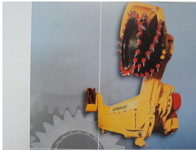
Hình 5 - Máy khâu than liên hợp KSW/E - 620 do ZMZ Balan SX (hiện nay)
