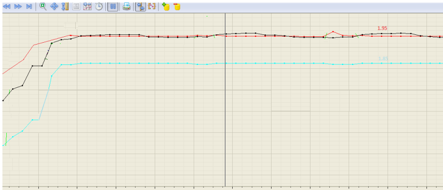
Hình 2.8: Biểu đồ quá trình ổn định tỷ trong huyền phù cho máy tuyến cấp 1 và cấp 2 từ khi khởi động hệ thống
