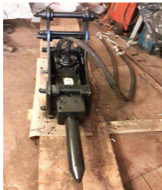
Hình 1. Búa thủy lực JCB HM380 sử dụng để phá đá quá cỡ tại các mỏ đá granite ở Việt Nam
