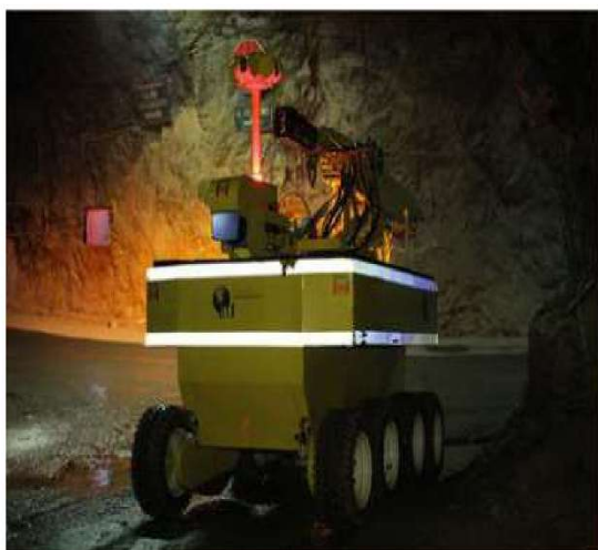
(a) Rô bốt lập bản đồ với hệ thống vị trí, định vị dưới lòng đất
