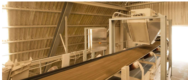
Hình 3. Máy phân tích FT-NIR lắp trên băng chuyền
