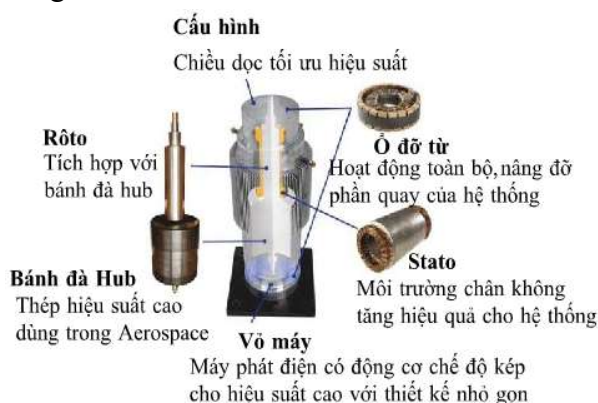
Hình 3. Cấu tạo của hệ thống FESS
