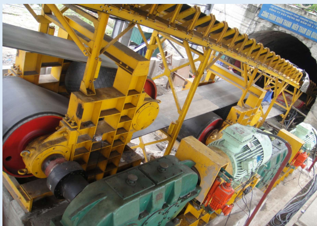
Băng tải lên dốc, băng tải hãm (xuống dốc), băng tải cong (địa hình), băng tải ống: Công suất đến 1.000 kW; góc dốc đến 25°
