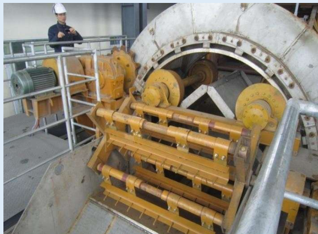
Máy tuyển huyền phù: Công suất 17,2 kW; năng suất đến 240 t/h
