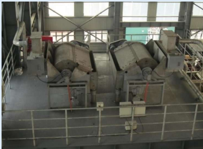
Máy tuyển từ: Công suất 16,5 kW; năng suất đến 270 m³/h
