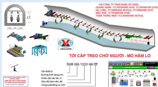
Tời cáp treo chở người: Công suất đến 55 kW; góc dốc đến 23°; năng suất đến 360 người/giờ/nhánh
