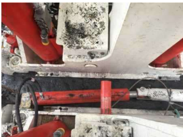
Hình 10. Kích đẩy cạnh để căn chỉnh đế giàn
