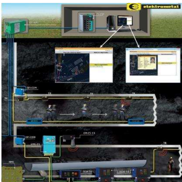
Hình 2: Hệ thống quản lý, định vị đèn lò thông minh SMARTLIGHT-12, Elektrometal (Ba Lan)
