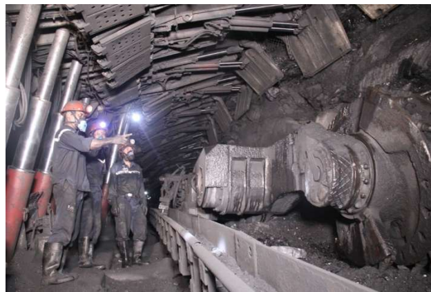
Hình 2. Lò chợ CGH hạng nhẹ công suất 300.000 tấn/năm của Công ty Than Hạ Long
