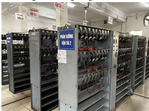
Hình 4: Hệ thống quản lý đèn lò tại Công ty Than Mạo Khê - TKV
