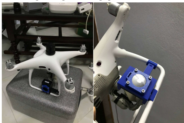
Hình 5. Bộ tìm kiếm máy bay (GPSTracker kết hợp Airtag)
